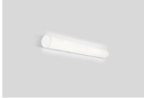
Rohrförmige Wandanbauleuchte aus Aluminium; Oberfläche Mattweiß; pulverbeschichtet; matte  $MacAdam \le 3 SDCM; CRI \ge 90;$  inklusive Leistungswahlschalter (Auswahl zwischen niedriger und hoher Leuchtkraft); Schutzart IP44; SK1; Lichtquelle durch autorisierte Fachleute austauschbar;
